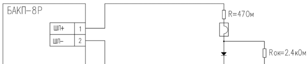
Подключение пиропатронов к БАКП-8Р Тип шлейфа "Реле с контролем цепи"
