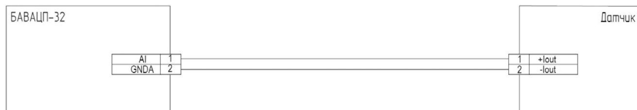
Схема подключения активных датчиков 0-20 мА/4-20 мА
