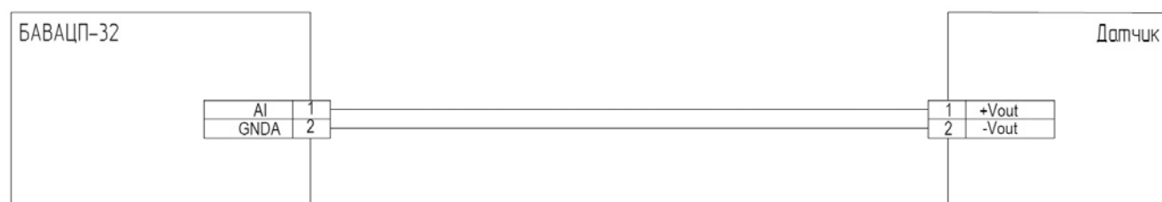
Схема подключения активных датчиков 0-5В, 1-5В, 0-10В
